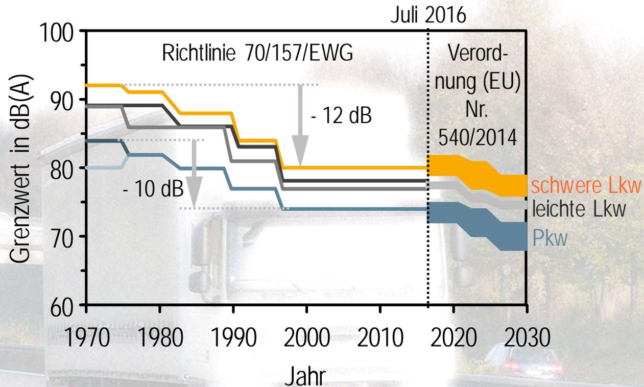
Die Geräuschgrenzwerte werden in einem festgelegten Verfahren überprüft. Aufgrund der Praxisferne des Prüfverfahrens ist die Abnahme der Geräuschemissionen der Lkw im realen Verkehr deutlich geringer, als die Absenkung der Geräuschgrenzwerte vermuten lässt.
