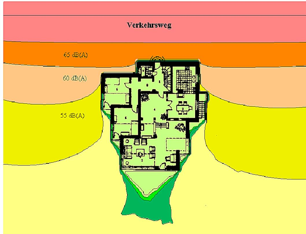
Durch den Versatz der Aufenthaltsräume können Fenster auf der schallabgewandten Seite angeordnet werden. Die Selbstabschirmung des Gebäudes ergibt dort Pegelminderungen bis zu 20 dB(A).
