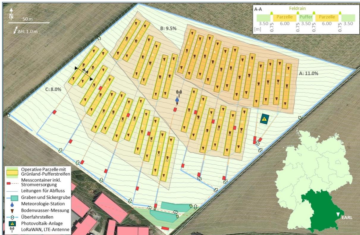
Abb. 10: Versuchsanlage des Erosion and Runoff Laboratory (EARL) in der Zukunftswerkstatt Ruhstorf. © Johannes Mitterer, Lfl
