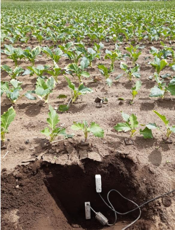
Abb. 9: Einbau von digitalen Bodenfeuchtesensoren. © Dr. A. Dümig, LWG
