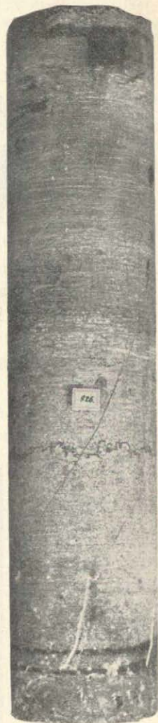
Figur 3. Bohrkern von Anhydrit aus 825 m Tiefe. (Etwas mehr als dreifach verkleinert.)
