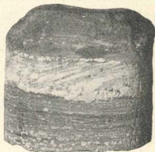
Figur 6. Bohrkern von Anhydritknotenschiefer. ( \frac{2}{3} der natürl. Grösse.) Die hellen Partien bestehen aus ver- gypstem Anhydrit.
