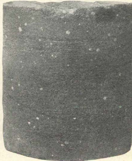
Figur 1. Bohrkern von Buntsandstein aus 323 m Tiefe (1/3).
