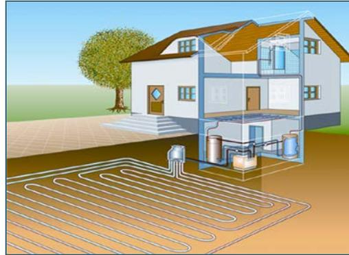
Abb.: Referenzobjekt in Oberfranken, Hof und eine schematische Darstellung einer Erdwärmekollektoranlage
