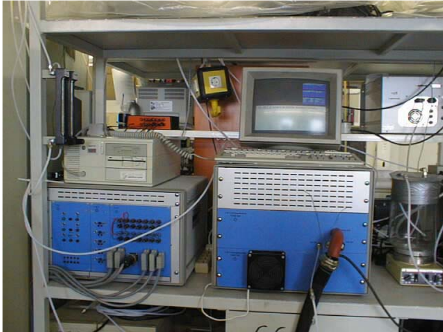
Abbildung 3.5: Aufbau des V & F CIMS 500
