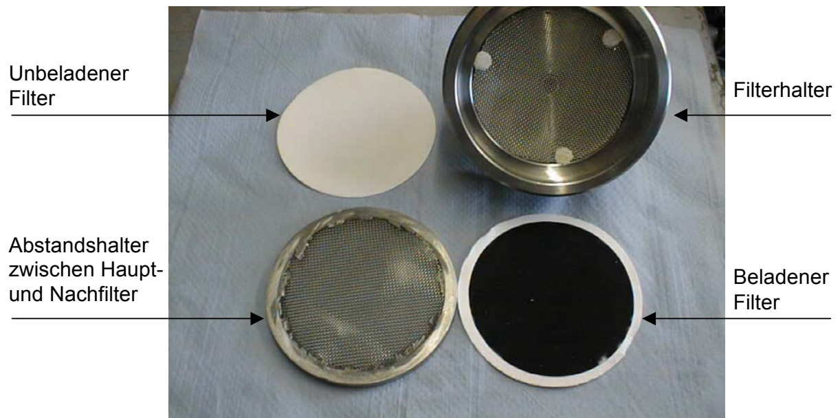
Abbildung 3.2: Ansicht des geöffneten des Partikelfilters
