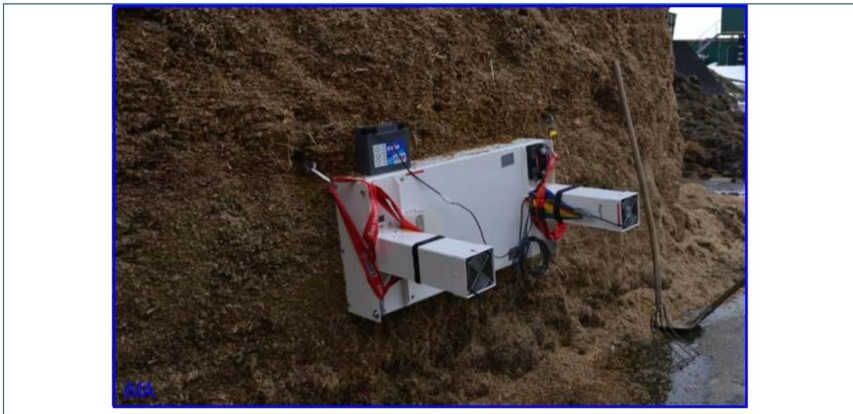
Abb. 10: Probennahme gemäß VDI 3880 [9] für >> 4 h alten Anschnitt Mais-Silage.
