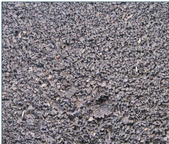
Abb. 8: Endprodukt der Gärresttrocknung
