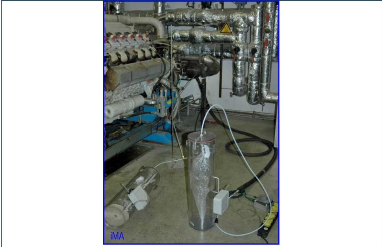
Abb. 4: Probenahme Olfaktometrie vor und nach Oxidationskatalysator am Gas-Otto-Motor
