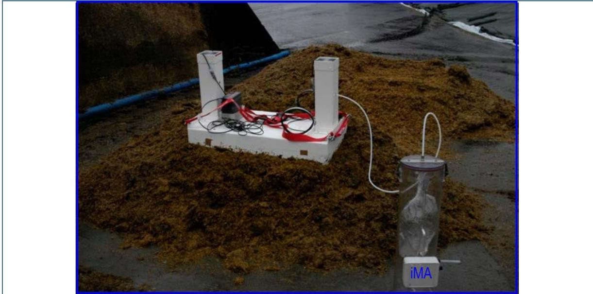
Abb. 9: Probennahme mit belüfteter Haube gemäß VDI 3880 [9] für frischen Anschnitt GPS-Silage.
