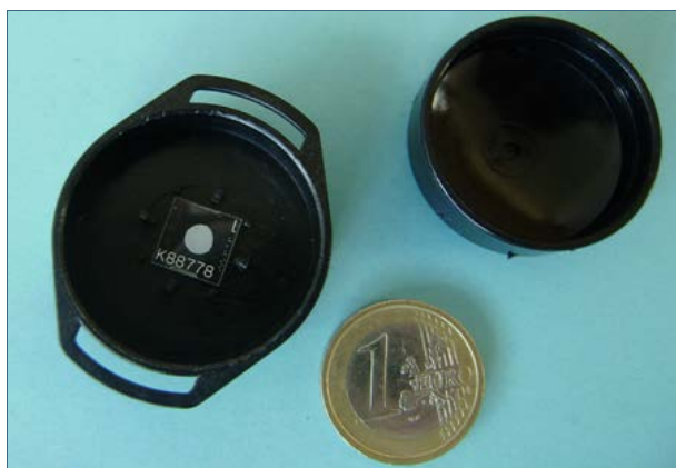
Abb. 3: Radon-Exposimeter: Ein Exposimeter mit einer genauen Gebrauchsanweisung erhalten Sie von den jeweiligen Laboren und Messstellen.
