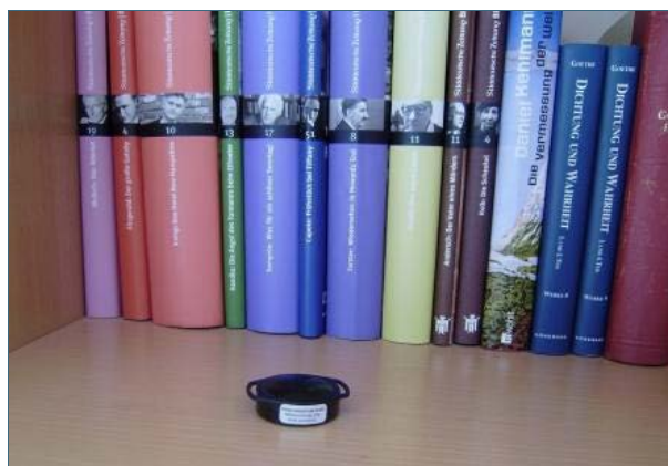
Abb. 3: Radon-Exposimeter: Ein Exposimeter mit einer genauen Gebrauchsanweisung erhalten Sie von den jeweiligen Laboren und Messstellen.
