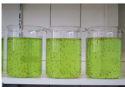
Abb. 14: Im Test zeigen Daphnien Schadstoffe an, indem sie sich weniger bewegen und schwächer vermehren.
