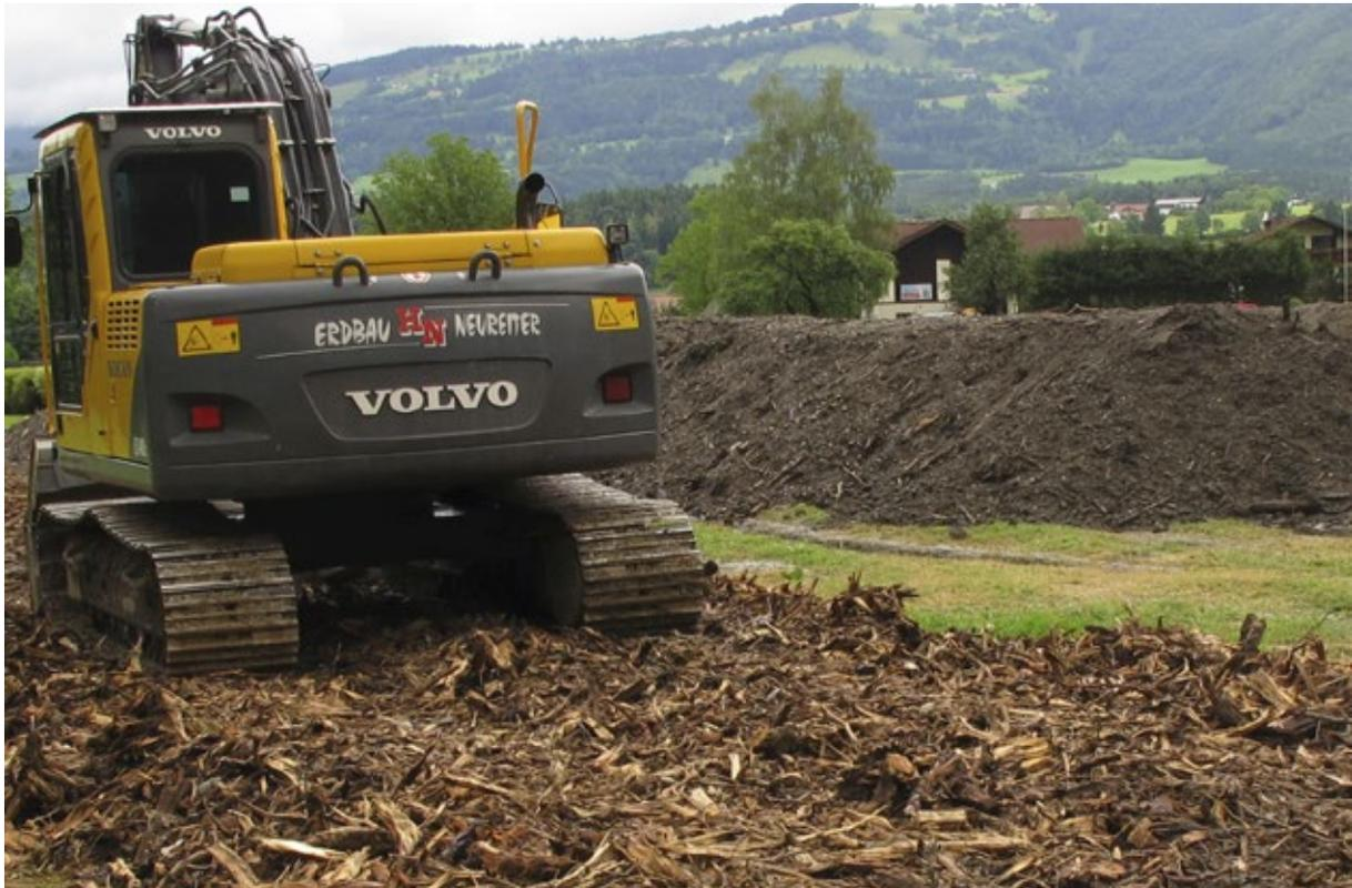
**Abb. 4:** Geschredderte Wurzelstöcke als Fahrgassenmaterial zwischen den Bodenmieten (Aufnahme vom 09.07.2014)
