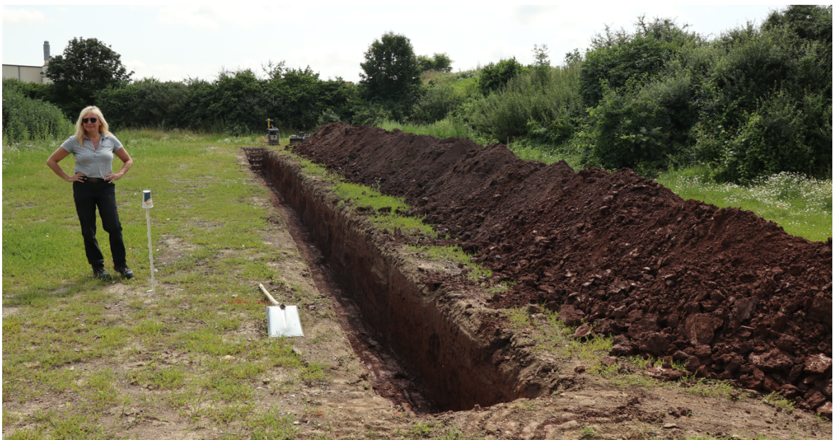
Abb. 4: Der Schurf im fertigem Zustand
