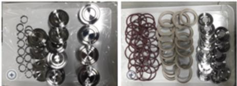
Abbildung 2: Bauteile der einzelnen Impaktorstufen. Links: Düsenplatten mit unterschiedlicher Bohrung, Isolationsringe (Bege) mit Ringsätzen und Folienhalterungen (rechts unten).
