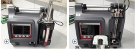
Abbildung 1: Impaktoreinheit mit Computereinheit und Elektromerleiaste. Die Bodenplatte wird mit den einzelnen Impaktorstufen in den Mantel und mit der Chargeinheit eingesetzt.
