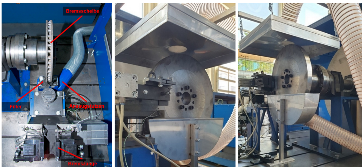
Abbildung 10: Bremsenprüfstand der Universität Bayreuth: Bremsscheibe mit Bremszange, keramischer Bremsscheibe und Absaugstutzen mit eingebrachtem Filter (links); innerhalb des Projektes entwickelte angepasste Absaugelemente mit einer Absaugung unter- und oberhalb der Bremsscheibe (Mitte, rechts).
