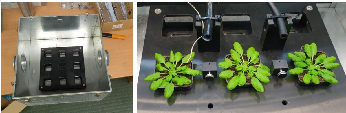
Abbildung 18: Für die Exposition von Pflanzen im Absaugstrang des Bremsenprüfstand der Universität Bayreuth ausgelegte Expositions-kammer (links). Versuchsaufbau mit 3 Pflanzen, Thermo-element (Draht in der linken Bild-hälfte) sowie Messschläuche des Impaktors ELPI (linker Schlauch) und „DMS500“ (rechter Schlauch) (rechts)
