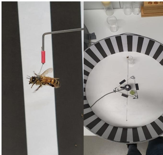
**Abbildung 9:** Biene am Auslegerarm einer Flugmühle (links). Flugmühle (magnetgelagert) von oben, eine Umdrehung beträgt einen Meter (rechts).
