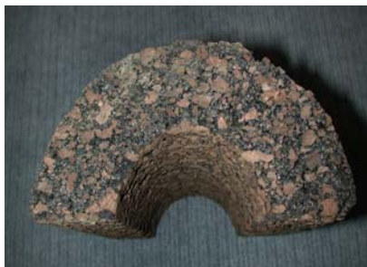
Rohrisolierung aus Teerkork
