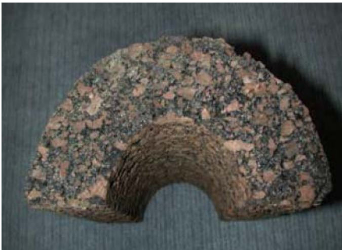
Abb. 5: Rohrisolierung aus Teerkork
