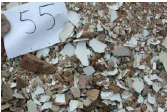
Abb. 1: abgetrennter Putz mit Farbanstrich
