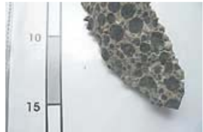
Detailaufnahme schlackehaltiger Leichtbeton
