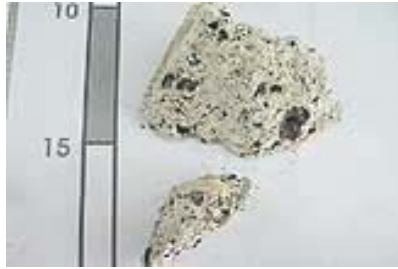
Detailaufnahme hellgrauer Porenbeton mit Schlackeanteilen
