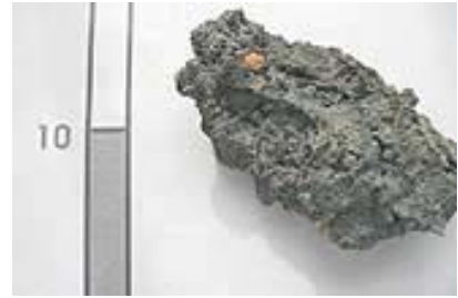
Porenbeton mit hohen Schlackenanteilen (Arsenhaltig)
