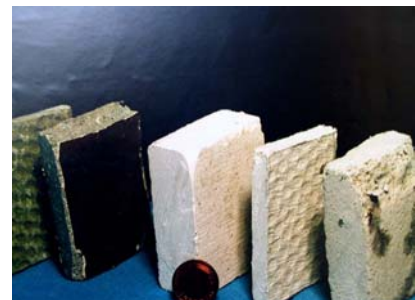
v.r.n.l. Sokalit, Baufatherm, Neptunit, Asbestzement
