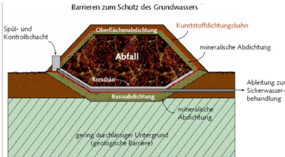
Abb. 2: Querschnitt durch eine Deponie
