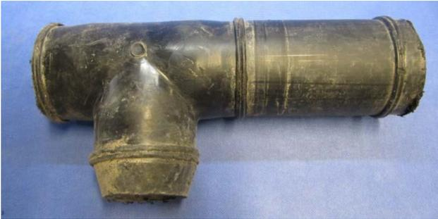
**Abbildung 8: Material C (Vollwandrohr mit T-Stück,  $d_A = 90$  mm, ca. 15 Jahre alt)**
