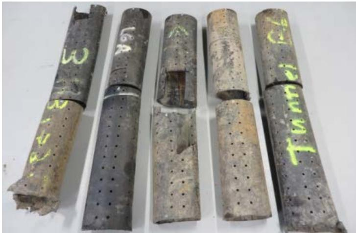
**Abbildung 4: Material Y: Drainage-Rohrstücke im Anlieferungszustand**
