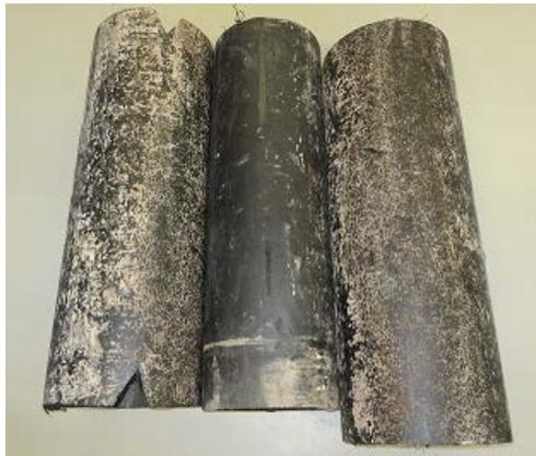
**Abbildung 5: Material Z: Drainage-Rohrstücke im Anlieferungszustand**
