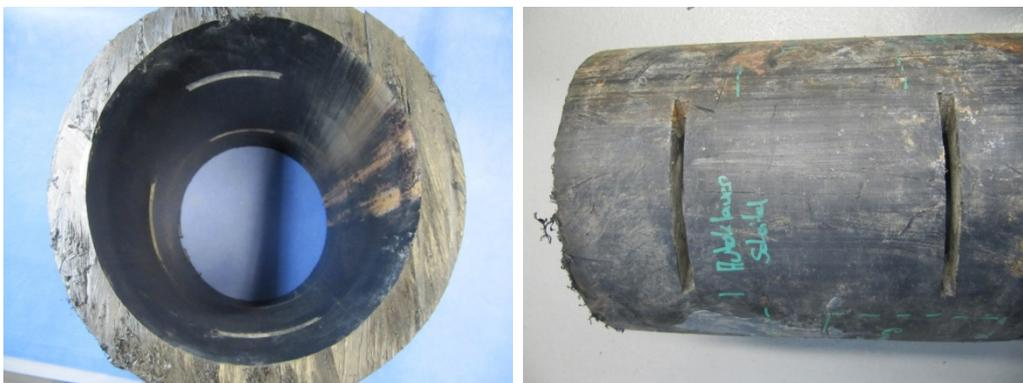
**Abbildung 7: Material B (geschlitztes Rohr,  $d_A = 250$  mm, 20 bis 25 Jahre alt)**
