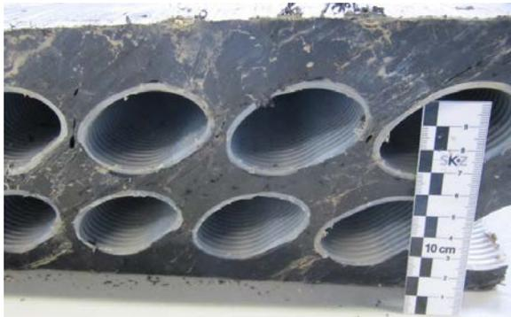
**Abbildung 2: Material X: Oberer Schachtteil „OS3“ im Anlieferungszustand als Repräsentant für die oberen Schachtteile**
