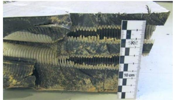
**Abbildung 3: Material X: Unterer Schachtteil „US2“ im Anlieferungszustand als Repräsentant für die unteren Schachtteile**
