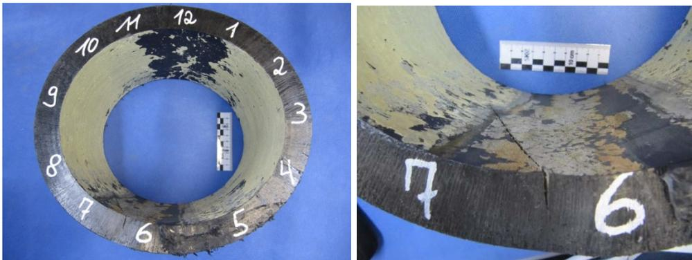
**Abbildung 6: Material A (Vollwandrohr,  $d_A = 280$  mm, ca. 20 Jahre alt); Riss in der Rohrinneenseite im Sohlbereich**
