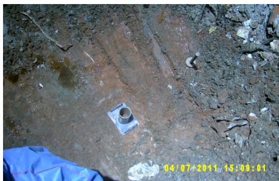
Entnahme von ungestörten Bodenproben aus der Basisabdichtung bei KS 1.
