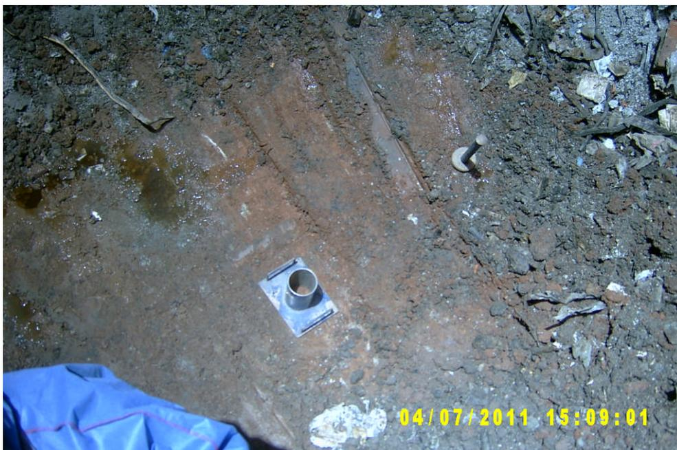
**Abbildung 3-1:** Entnahme von ungestörten Bodenproben aus der Basisabdichtung bei KS 1.
