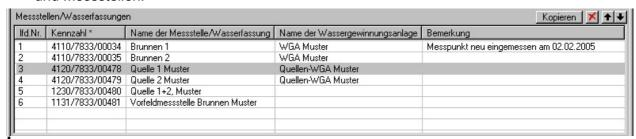
**C)** Im dritten Abschnitt können Sie zu einer markierten Wasserfassung oder Messstelle des zweiten Abschnitts die Messdaten erfassen. Die Messdatenerfassung für den EÜV-Jahresbericht erfolgt auf der Registerkarte Monatswerte:
