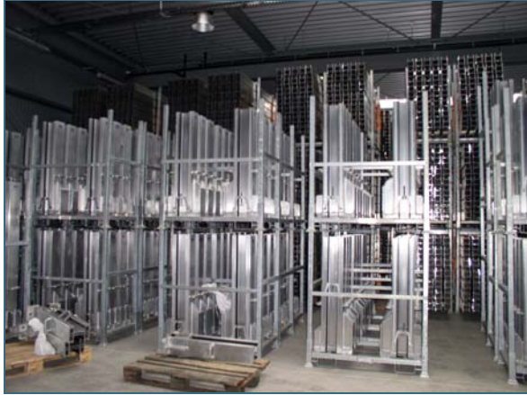
Abb. 17: Lagerhalle in Köln - alle Bauteile müssen rutschfest auf den vorgesehenen Paletten gelagert werden; die Einlagerung in der Halle erfolgt nach den Vorgaben des Lagerplanes
