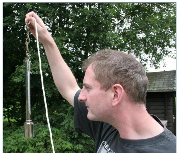
Abb. 10: Ablesen der Wassertemperatur von der Skala des Schöpfthermometers
