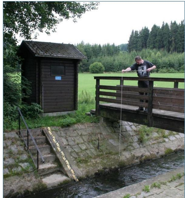
Abb. 9: Einbringen des Schöpfthermometers ins Wasser von einem Messsteg aus
