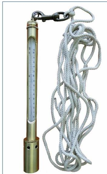
Abb. 6: Schöpfthermometer mit geöffnetem Skalenschutz
