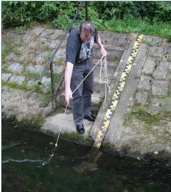
Abb. 8: Einbringen des Schöpfthermometers ins Wasser von der Pegeltreppe aus
