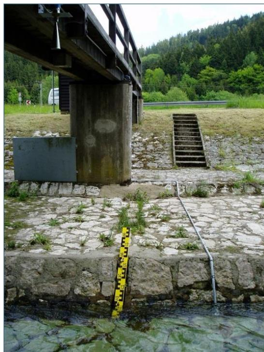
Abb. 1: Installation der Temperatursonde im Niedrigwassergerinne eines Pegels
