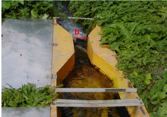
Abb. 4: Venturikanal (Foto: BMLFUW)
