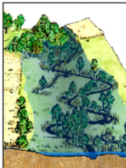
▲ Bach, ausgebaut: Sohle eingetieft, Ufer erodiert, Nutzung bis ans Ufer => Hier hilft eine Gewässeraufweitung mit Sohlanhebung.
