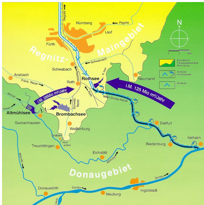
Abb. 5.2 Systemskizze des Überleitungssystems
