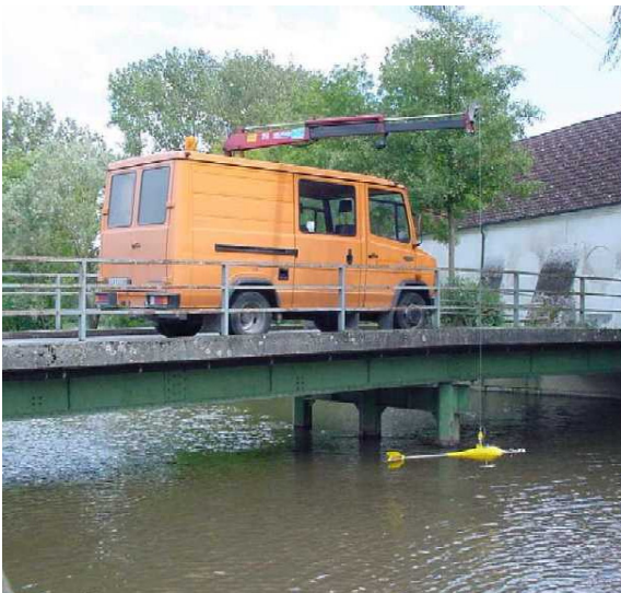
Abflussmessung mit einem Messflügel und dem Messwagen des WWA Landshut
