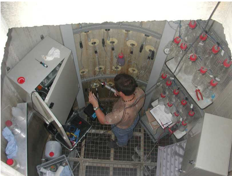
Gewinnung von Bodensickerwasser vom Messschacht unter einer Ackerfläche bei Straubing
