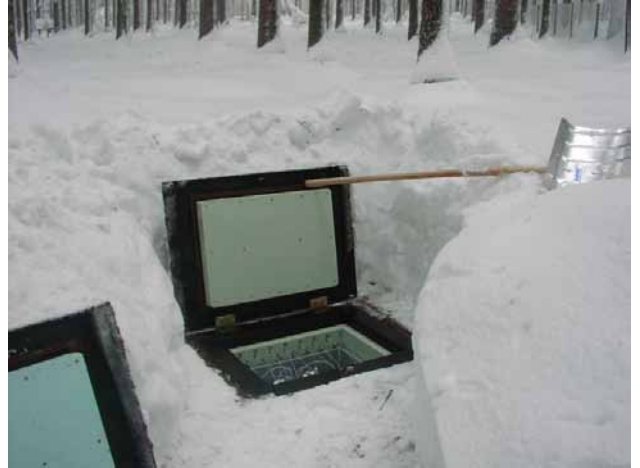
Sammelkasten zur Gewinnung von Bodensickerwasser im winterlichen Fichtelgebirge
