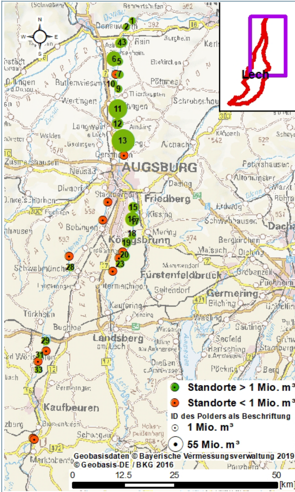
Abb. 4: Identifizierte Standorte für Hochwasserrückhaltebecken im Nebenschluss im Einzugsgebiet des Lechs
