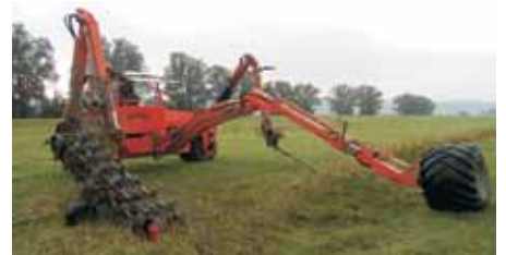
Diese futuristisch anmutende Graben-Mähmaschine ermöglicht eine optimale Erhaltung von Gräben. Die Wiese wird geschnitten und gleich zusammengereicht.
