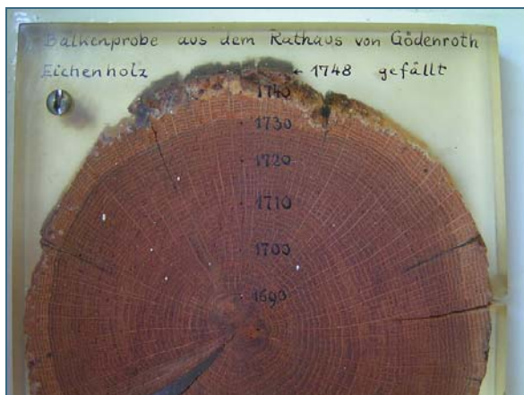
Abb. 1: Für Jahresringkalender eignen sich Balken aus alten Fachwerkhäusern, Hölzer aus historischen Bauten und aus archäologischen Fundstellen. Auch noch ältere Bäume, die in Kiesgruben oder Mooren konserviert wurden, können verwendet werden. Wichtig ist, dass jeder Ring genau datiert werden kann, wie etwa bei der abgebildeten Balkenprobe aus dem Rathaus von Göttenroth.
