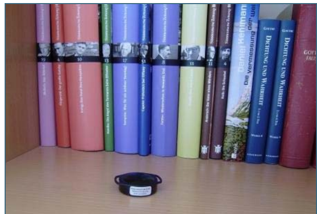
Abb. 3: Radon-Exposimeter: Ein Exposimeter mit einer genauen Gebrauchsanweisung erhalten Sie von den jeweiligen Laboren und Messstellen.
