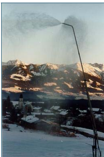
Abb. 1: Ein Beispiel für die Hochdruck-Technik sind die mehrere Meter hohen Schneelangen (auch Schneilangen genannt). Durch die große Fallhöhe hat das versprühte Wasser lange Zeit zum Gefrieren, bevor es auf die Piste fällt. Die hoch montierten Anlagen sind jedoch windempfindlich.
