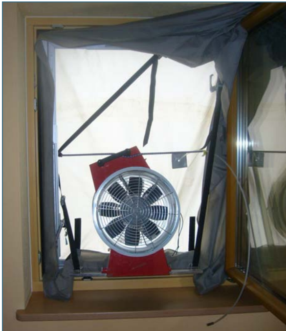
Abb. 16: Luftdichtheitstest zur Qualitätskontrolle in einem Wohnhaus
