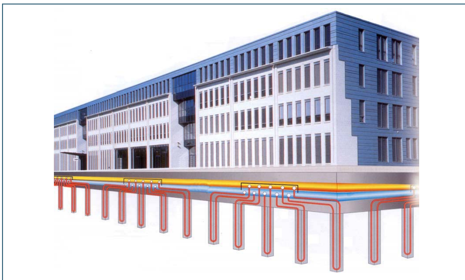
Abb. 6: Erdberührte Betonbauteile – wie die 570 Gründungspfähle unter dieser Industrieanlage – erschließen das Erdreich als Wärme- bzw. Kältequelle. 2
