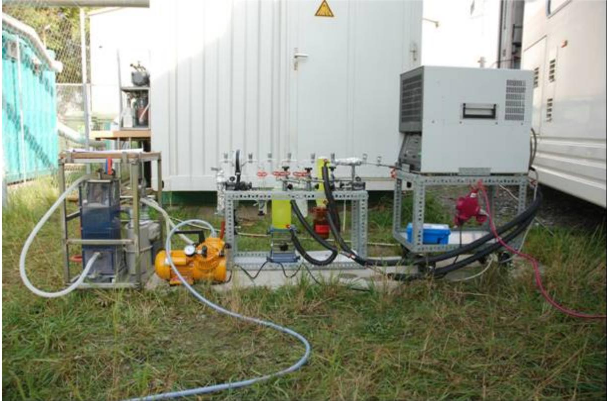
Abb. 6 PCDD/PCDF-Probenahme des Deponiegases an der Deponie C
