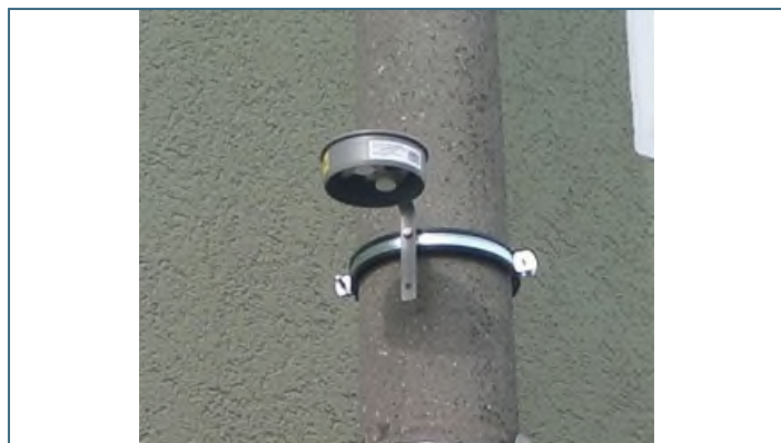
Abb. 4: Witterschutzgehäuse mit Passivsammlern; die beiden Sammeleinheiten sind als weiße Plastikkapseln gut zu erkennen
