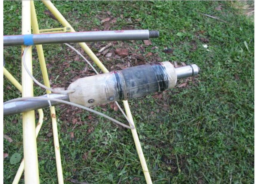
Das Packersystem mit Klebeband zu umwickeln oder abzudichten kann zu Undichtigkeiten und Querkontaminationen führen.
