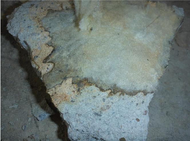
Abb. 3 Estrich mit KMF-Anhaftung
