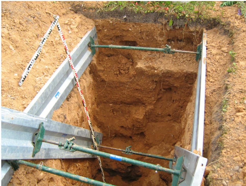
**Abbildung 5-3:** Fotodokumentation: bodenkundlicher Schurf der Rekultivierungsschicht, Deponie Weiden-West
