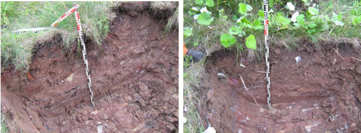
**Abbildung 5-4:** Fotodokumentation: bodenkundlicher Schurf 1 (links) und Schurf 2 (rechts) in der Rekultivierungsschicht, Versuchsfeld E 54, Deponie Bayreuth-Heinersgrund
