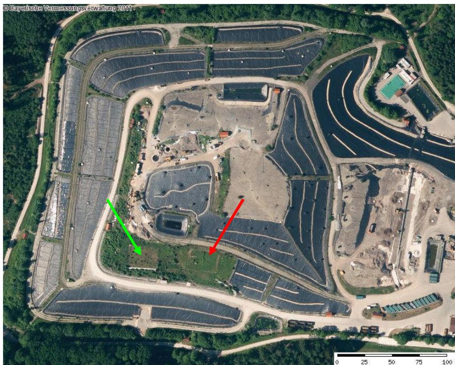
**Abbildung 2-1:** Luftbild der Deponie „Im Dienstfeld“. Die Deponie ist überwiegend mit Folie temporär abgedichtet. Pfeile: Lage der Versuchsfelder E 35 (roter Pfeil) und E 50 (grüner Pfeil).
