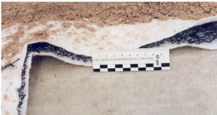
**Abbildung 5-3:** Dränmatte (Detailaufnahme).
