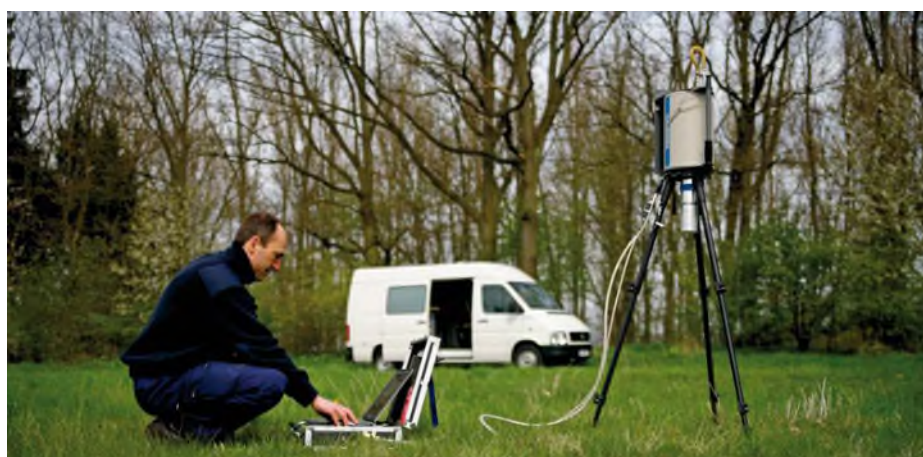
Abb. 7: Routinemäßig misst das LfU die Strahlung in der Umgebung kerntechnischer Anlagen mit In-Situ-Gamma-Spektrometrie.
