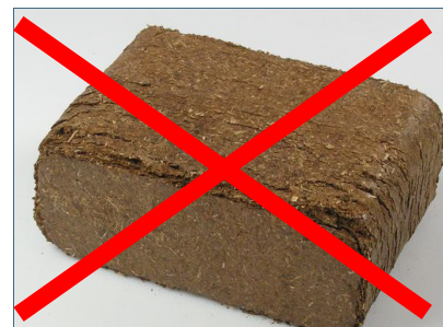
Abb. 7: Auch Rindenbriketts dürfen in Kaminöfen nicht verbrannt werden, der hohe Gehalt an Salzen führt zu sehr hohen Staubemissionen.
